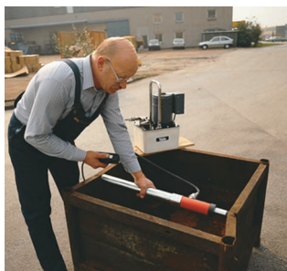
выправка контейнера с помощью гидроцилиндра YS-10/100, трубы-удлинителя AYS-106, опоры-адаптера AYS-103 и электронасоса PY-04/2/5/2M
