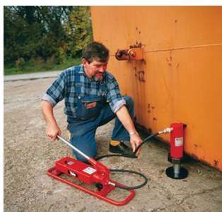
подъём контейнера с помощью гидроцилиндра YS-23/160, подхвата AYS-23, наконечника AYS-232 и ручного насоса HPS-2/2 с опорной рамой
