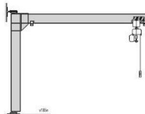
Кран с креплением на полу и стене
